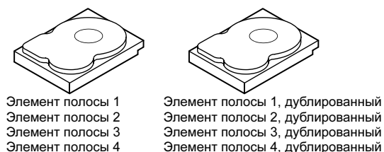
Рисунок 1-3. Пример конфигурации Integrated Mirroring (RAID 1)
