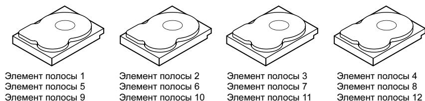
Рисунок 1-2. Пример конфигурации Integrated Striping (RAID 0)
